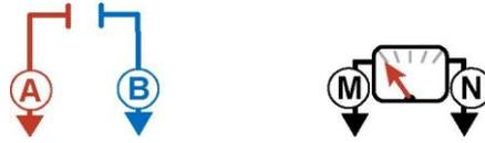
Le dipôle-dipôle est un dispositif où MN est à l'extérieur de AB. L'avantage de celui-ci est de n'exiger que des longueurs de câble beaucoup faibles pour une profondeur d'investigation donnée. Il nécessite cependant un appareillage très sensible, car si la profondeur d'investigation croît avec la distance entre A et B, le  $\Delta V$  que l'on mesure entre M et N décroît avec le cube de cette distance (dans un Schlumberger le  $\Delta V$  décroît avec le carré de cette distance).
